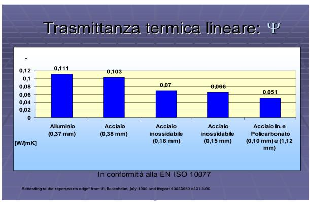
Il grafico mostra come i fenomeni di condensa non siano completamente eliminabili ma, utilizzando distanziatori warm edge possano essere notevolmente ridotti con beneficio anche del serramento in termini di durata.
